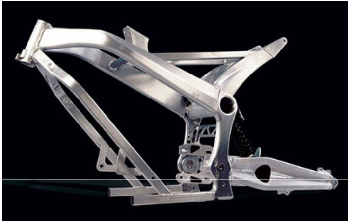
Okviri modernih motocikala od aluminijumskih zavarenih profila
