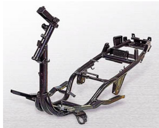
Okviri mopeda od presovanog zavarenog lima - lijevo i cijevnih profila desno
